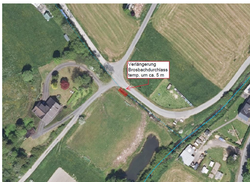
Abb.7 temp. Verlängerung Brosbachdurchlass
